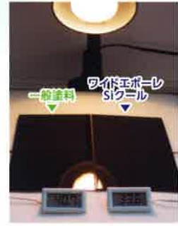
銅板面に塗装し、レフランプの光を当て、表面温度を測定
